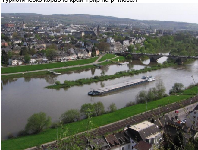
Кораб за насипни товари на фона на гр. Трир на р. Мозел. Правят впечатление плъзгащите се твърди капацци на хамбарите.
