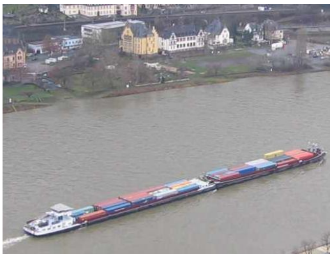
По-близкият кораб от снимката вляво – речен контейнеровоз. Прави впечатление, че корабът е и тласкач на шлепа пред него.
