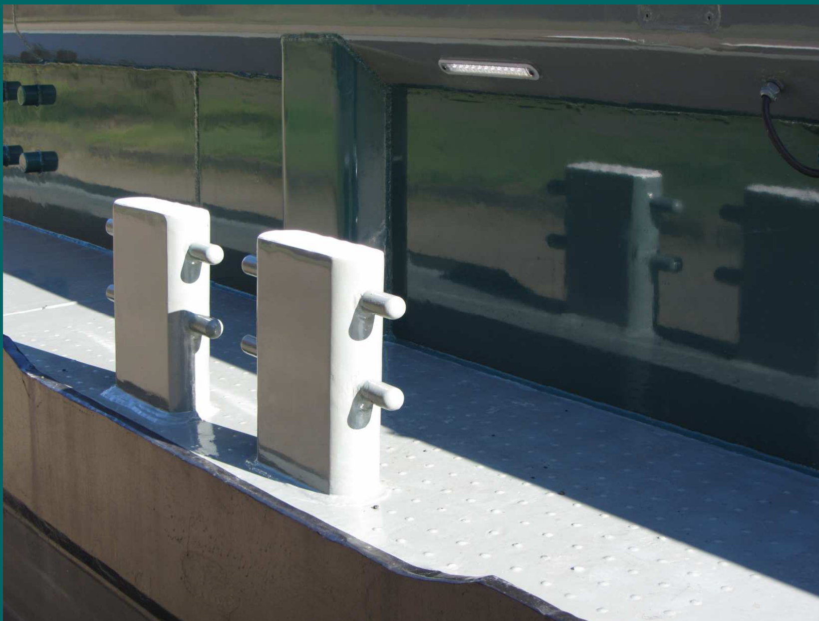
Фрагмент от м/к "Аргус". Не е за вярване, че този кораб превозва въглища. Но е факт. Кнехтовете имат осветление със светодиоди.
